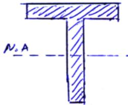
۶۳- دیاگرام تنش در مقطع شکل زیر که تحت اثر لنگر خمشی منفی قرار دارد کدام است؟
