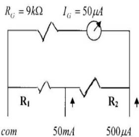
۶۱- برای توسعه حدود اندازه گیری جریان یک گالوانومتر قاب گردان از شنت آئرتون مطابق شکل زیر استفاده شده است . مقاومت  $R_1$  چند اهم است ؟
