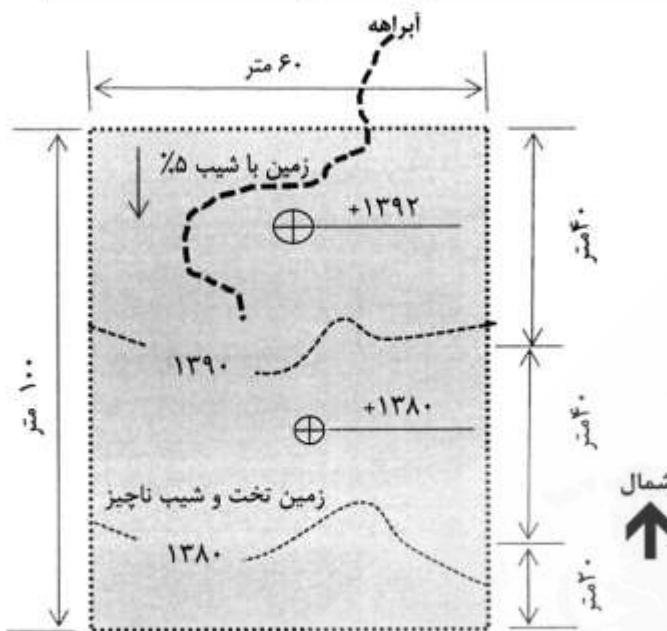
در شکل مقابل پلان محدوده قطعه زمینی کوهستانی با ابعاد مستطیل ۶۰ متر در ۱۰۰ متر در دو قسمت شده و به صورت دو تراس با شیب ملایم و اختلاف ارتفاع ۱۰ متر دیده می‌شود. زمین در منطقه معتل و با یارندگی خوب سالانه قرار دارد و یک آبراهه طبق شکل از قسمت شمالی وارد یک حوضچه در تراس بالایی می‌شود. سایر اطلاعات را فرضی درنظر بگیرید.
