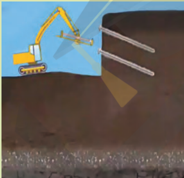
پایدارسازی شیب به روش میخ کوبی
