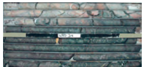
الف) مغزه‌گیری با گمانه‌های اکتشافی
