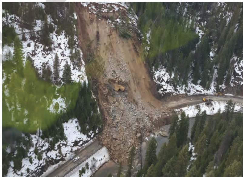
شکل ۹-۴- زمین لغزش در یک جاده
