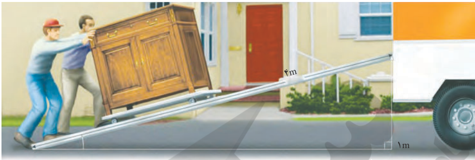
شکل ۱۷ - استفاده از سطح شیب‌دار جابه‌جایی جسم‌های سنگین را آسان‌تر می‌کند.
