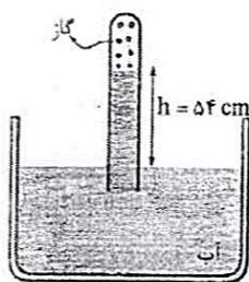
در شکل رویه رو، فشار گاز جمع شده در انتهای لوله،  $70 \text{ cmHg}$  است. چگالی آب  $1 \text{ g/cm}^3$  و چگالی جیوه  $1.35 \text{ g/cm}^3$  است. اگر اختلاف سطح آب در لوله و ظرف  $54 \text{ cm}$  باشد فشار هوا چند سانتی متر جیوه است؟
