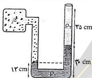
در شکل رویه رو فشار پیمانه ای گاز درون مخزن چند پاسکال است؟
