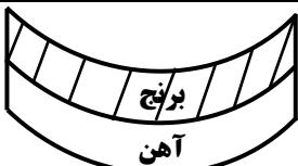
اگر آهن  $\alpha >$  بینج  $\alpha$  باشد، در شکل مقابله دمای میله‌های پرچ شده افزایش یافته است یا کاهش؟ چرا؟
